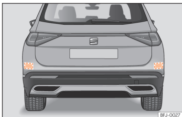
Afb. 135 Achteraanzicht van de wagen: zones van de radarsensoren.
