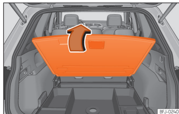
Afb. 199 In de bagageruimte: verstelbare bodem optillen.
