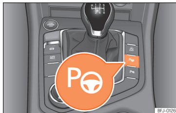
Afb. 162 In de middenconsole: toets om het inparkeersysteem in te schakelen.
