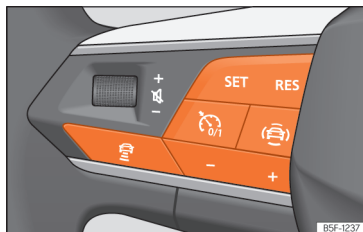
Afb. 141 Op het multifunctiestuurwiel: knoppen voor bediening van ACC.
