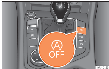
Afb. 122 Middenconsole: toets van het start-stopsysteem.
