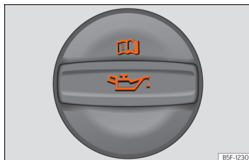
Afb. 243 In de motorruimte: dop van de motorolie-vulopening.
