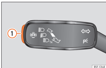
Afb. 130 Knipperlicht- en grootlichthendel: toets voor de bestuurdershulpsystemen (naargelang het model).
