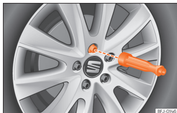
Afb. 257 Wiel verwisselen: de wielbouten met de schroevendraaiergreep losdraaien.
