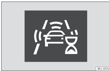
Afb. 146 In het display van het instrumentenpaneel: aanwijzing van initiële zelfkalibratie van het systeem.
