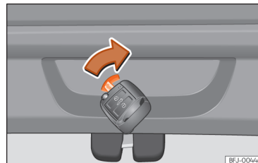
Afb. 80 Deel van de bagageruimte: noodontgrendeling.
