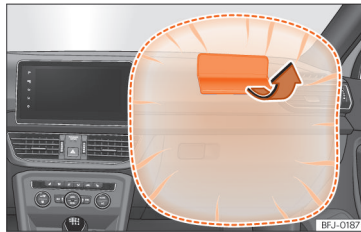
Afb. 32 Bijrijdersairbag in het dashboard.
