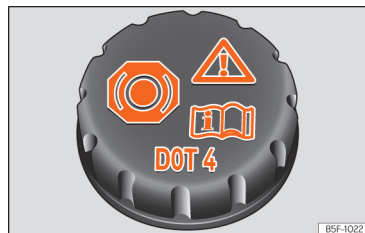
Afb. 238 Motorruimte: dop van het remvloeistofreservoir.
