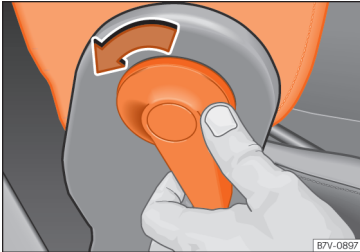
Afb. 91 Inklapbare rugleuning van de bijrijdersstoel ontgrendelen.
