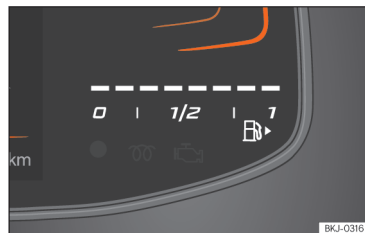
Afb. 6 Basic instrumentenpaneel: brandstofmeter.
