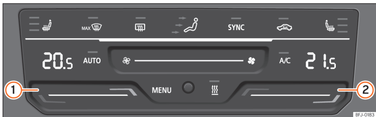
Afb. 113 In de middenconsole: bedieningselementen van Climatronic.
