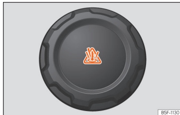
Afb. 237 Voorruimte: vuldop van het koelvloeistofexpansiereservoir.
