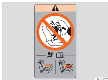
Afb. 41 Airbagsticker: in de achterste omlijsting van het bijrijdersportier.
